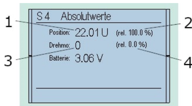
Bild 68: 1... Absolutwert der Positionseinheit, 2... Relativwert der Positionseinheit, 3 und 4... Absolut- und Relativwert der Drehmomenteinheit (wird im Werk kalibriert)
