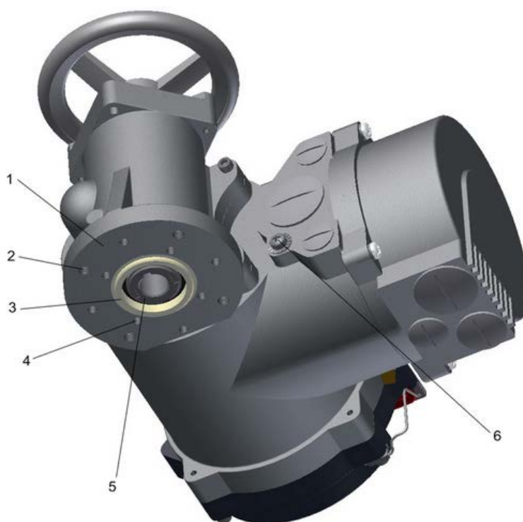
Bild 9: 1...Montageflansch, 2...Bohrbild G0/F10, 3...Zentrierrand, 4...Bohrbild F07, 5...Wellenverbindung, 6...Erdungsanschluss
